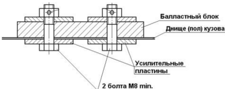
Рис.1. Крепление балласта.
