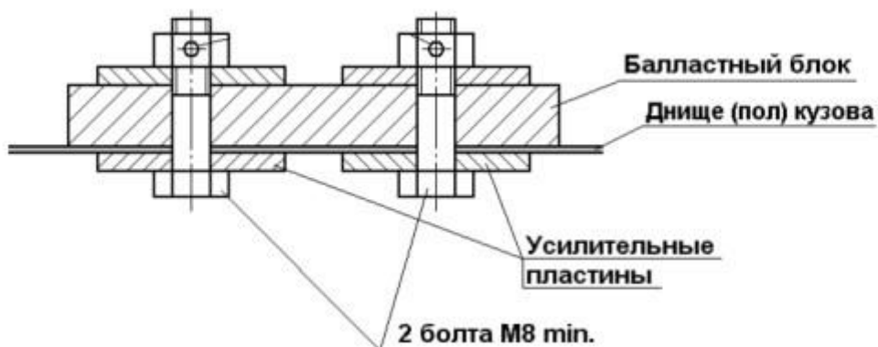
Рис.1. Крепление балласта.
